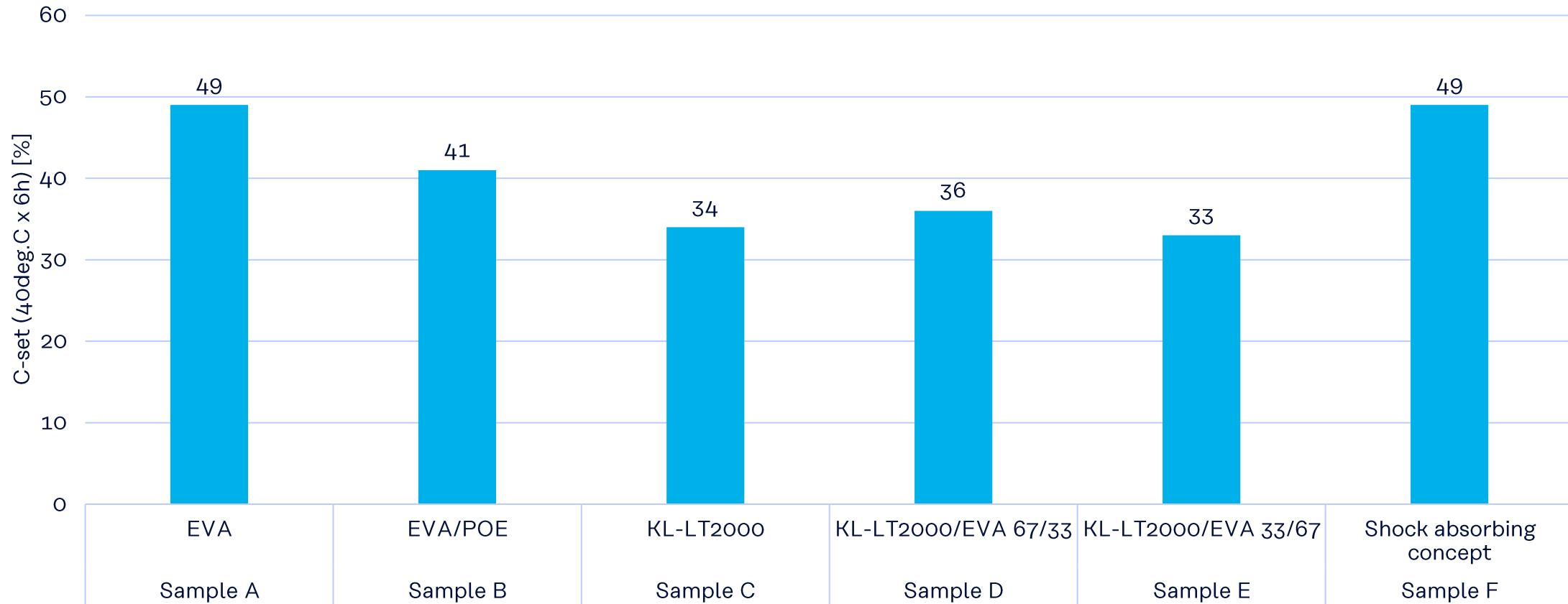
✓ La espuma basada en KL-LT2000 muestra una mejor deformación por compresión que la espuma basada en EVA
